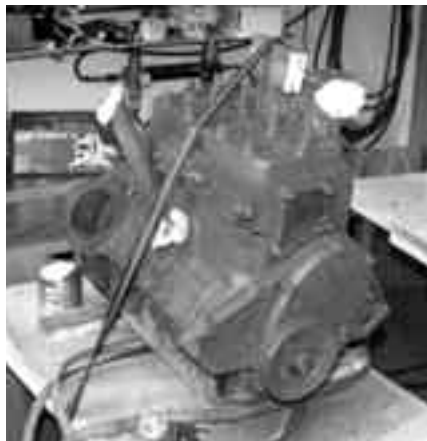
Dette er den udskældte sideventilede motor, som Minoren havde ved introduktionen i Danmark i 1949
